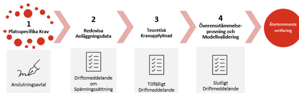
Figur 5. Översikt över processen för anslutningsförfarandet av en kraftparksmodul av typ C och D.
