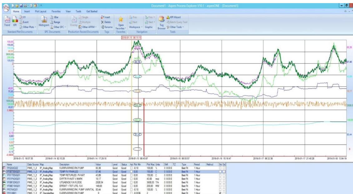
Figur 12 Momentanbild som visar pumpeffekt vid höga flöden där alla tre pumpar är igång.
