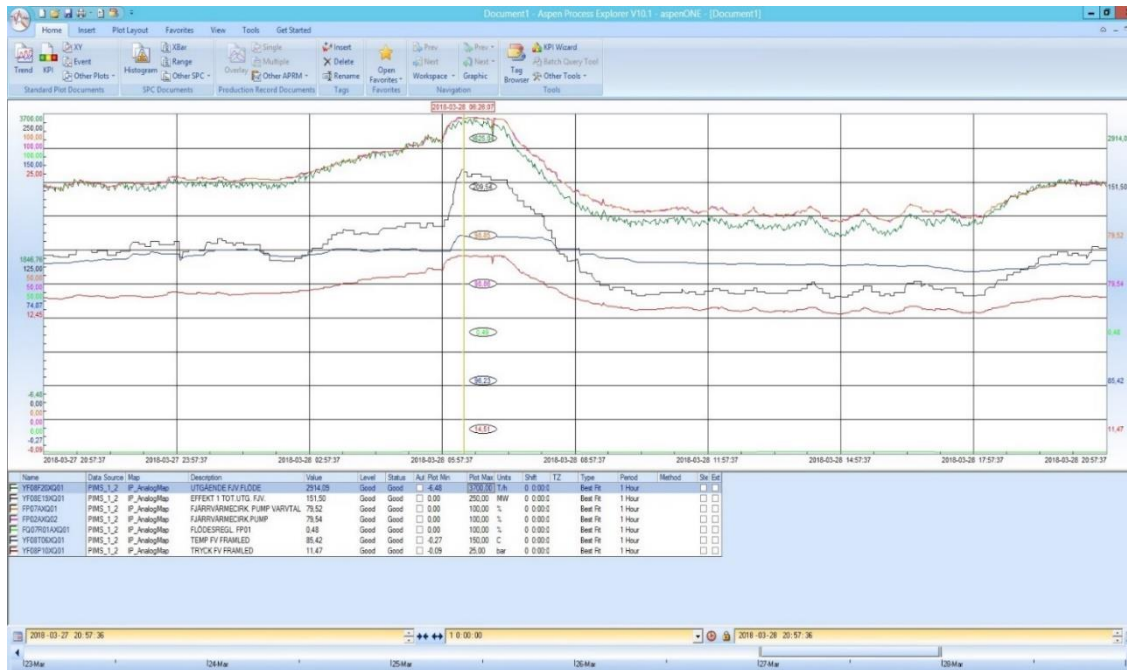
Figur 11 Momentanbild som visar pumpeffekt vid höga flöden där bara FP02 och FP07 är igång.
